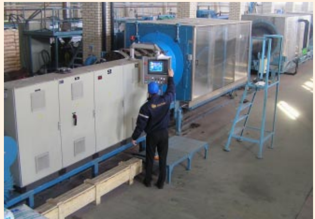
2005 г., Санкт - Петербург. Цех предприятия по производству напорных полиэтиленовых трубопроводов. На линии - труба для водоснабжения диаметром 1200 мм из ПЭ 100.
